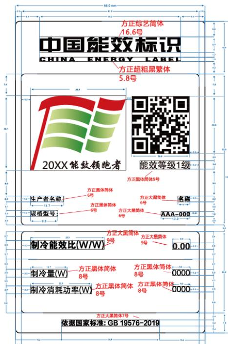
图 5 通讯基站用单元式空调机能源效率标识样式示例
