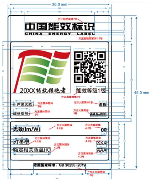
图2 定向集成式LED灯能源效率标识样式示例
