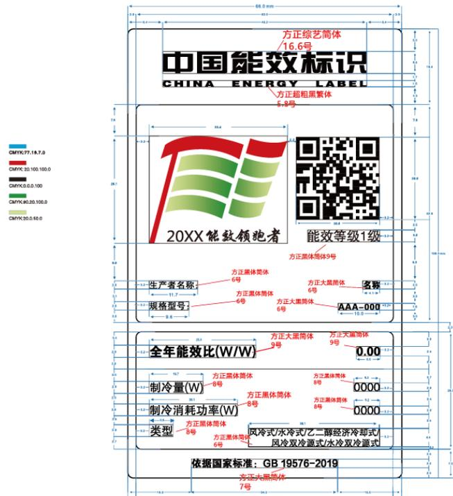
图 4 计算机和数据处理机房用单元式空调机能源效率标识样式示例
