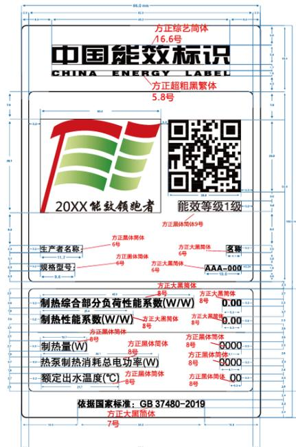
图 2 低环境温度空气源热泵（冷水）机组能源效率标识样式示例 2
