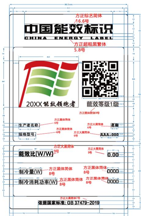
图 4 直接蒸发式全新风空气处理机组能源效率标识样式示例
