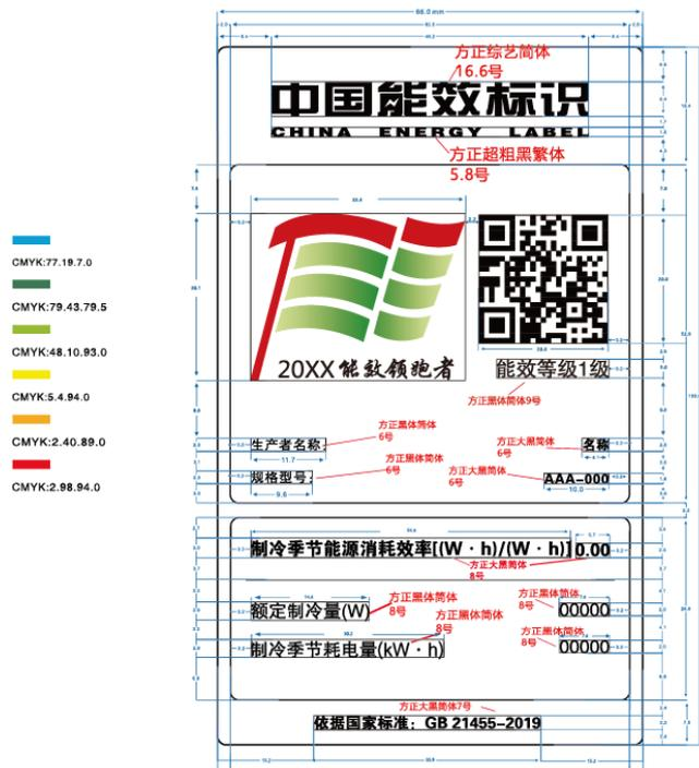
图 1 单冷式房间空气调节器能源效率标识样式示例
